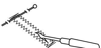
6 Петля будет прошита автоматически в последовательности, указанной на рисунке. По завершении выполнения петли машина остановится автоматически с иглой в верхнем положении. Нажмите кнопку обрезки нити и выньте ткань.
