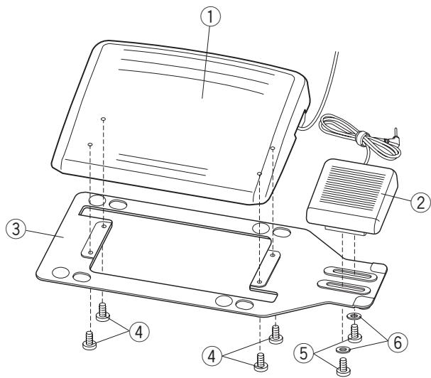
Присоедините педаль контроля скорости ① и педаль обрезки нити ② к пластина крепления ③, закрепив их винтами крепления ④ и винтами ⑤ с шайбами ⑥, как показано на рисунке.
