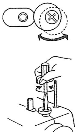
**ПРИМЕЧАНИЕ:** Положение стопора намотки возможно регулировать в зависимости от необходимого количества нити на шпулке (например, половина или полная). Отверткой ослабьте винт для регулировки положения шпинделя. Не отворачивайте винт полностью.
