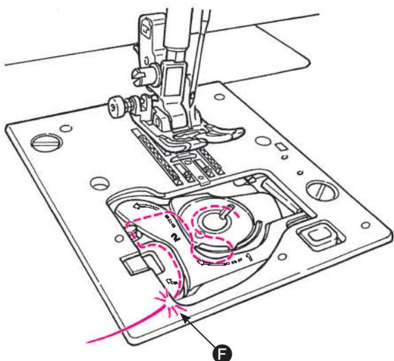
**5** Обрежьте нить при помощи встроенного обрезывателя **F**.
