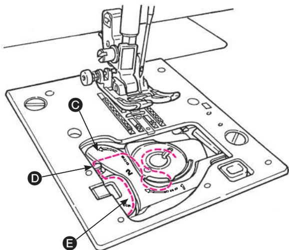
**4** Протяните нить через направляющие **D** и **E** и оставьте нить внизу. (Протяните нить сначала через направляющую **E**, а затем к направляющей **D**.)
