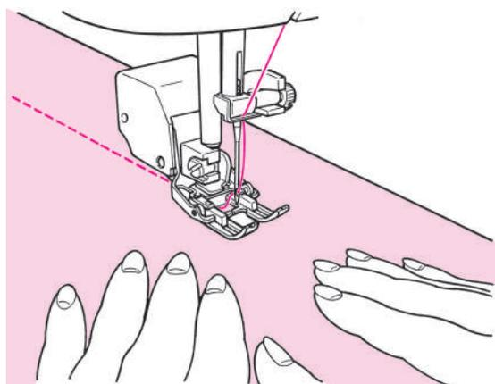
Квилтинг – процесс стачивания верхнего слоя ткани, промежуточного хлопчатобумажного и нижнего слоя. При помощи шагающей лапки машина перемещает сразу верхний и нижний слой ткани и смещения одного слоя относительно другого не происходит.
