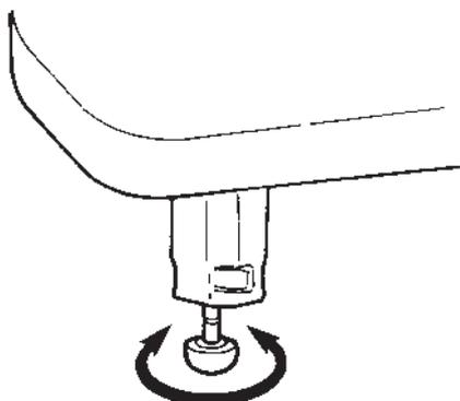
**4** Отрегулируйте высоту ножек, чтобы его поверхность располагалась на уровне корпуса машины.
