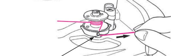
**5** Вставьте конец нити в направляющую у оси для намотки шпульки и дерните ее вправо, чтобы обрезать.
