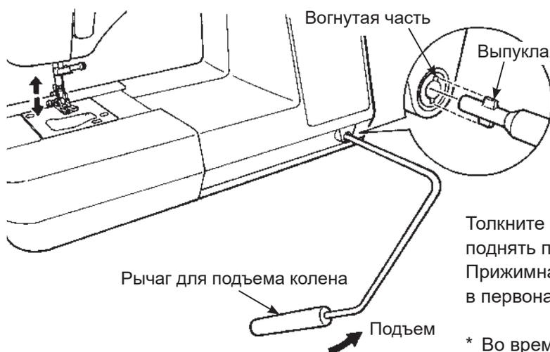
Вставьте коленоподъёмник к отверстию таким образом, чтобы вогнутая и выпуклая части состыковались.
