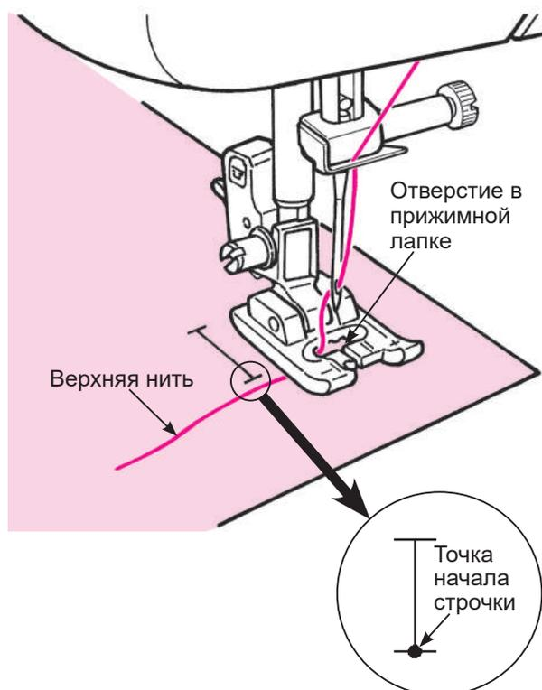
**1** Установите лапку для выметывания петель вручную (I).
