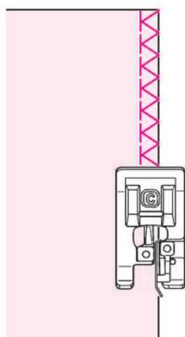
Этот вид строчки предназначен для обработки краев средних и плотных материалов. Разместите ткань вдоль направляющей линии и начинайте выполнять строчку.
