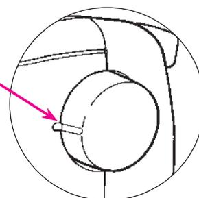
**1** Поднимите рычаг для поднятия прижимной лапки.
