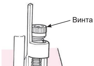
**4** Выключите машину и отрегулируйте высоту подъема лапки с помощью регулировочного винта.
