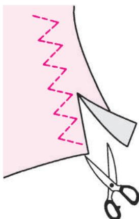
Этот вид строчки используется для предотвращения изнашивания ткани по краям. Отступите немного от края ткани и выполните строчку, затем обрежьте край ткани осторожно ножницами, не задевая строчку.
