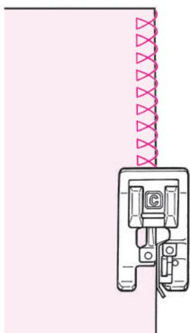
Этот вид строчки предназначен для обработки краев средних и плотных материалов. Разместите ткань вдоль направляющей линии и начинайте выполнять строчку.
