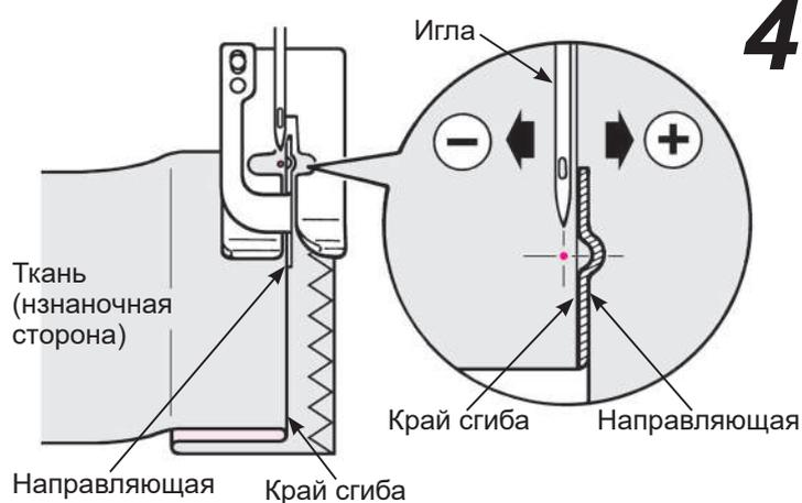
**4** Выровняйте край сгиба ткани по направляющей прижимной лапки. Поверните маховик и отрегулируйте ширину строчки зигзаг при помощи регулировочного диска таким образом, чтобы стежки достигали до края сгиба.
