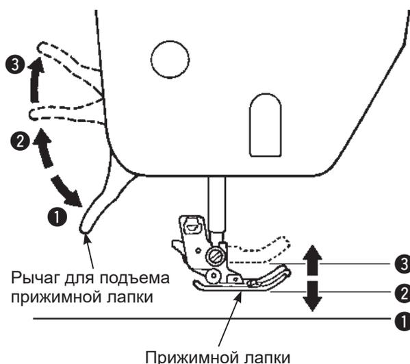
Перемещение прижимной лапки вверх/вниз осуществляется с помощью рычага подъёма прижимной лапки.
