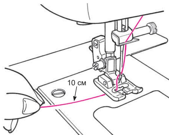
**1** Протяните верхнюю нить через отверстие в прижимной лапке.
