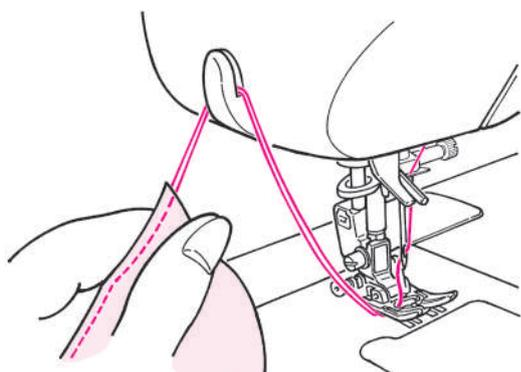
\* Вы также можете перерезать нити при помощи механизма обрезки нитей, расположенного у крышки лицевой панели.
